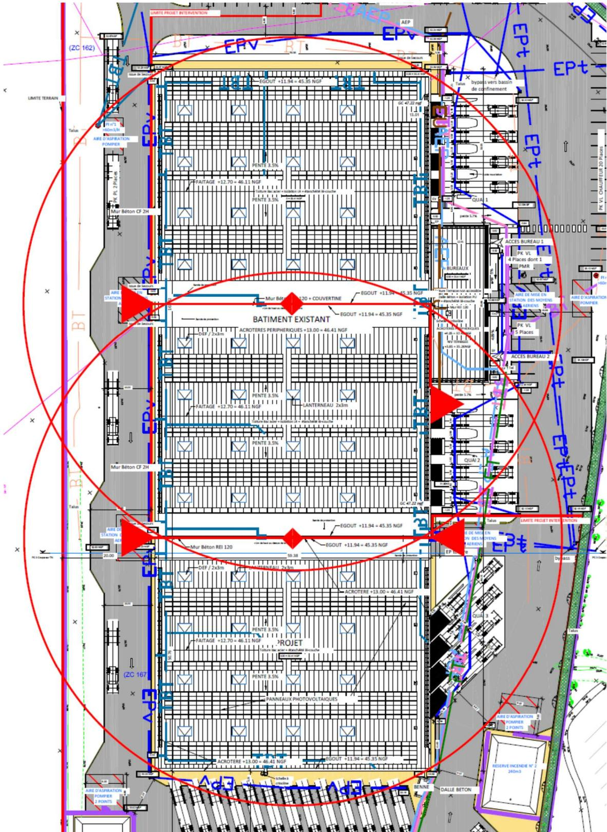
PDA de 60  $\mu$ s sur mât de 5 m => Niveau de protection III => Rp-40% = 58 m
