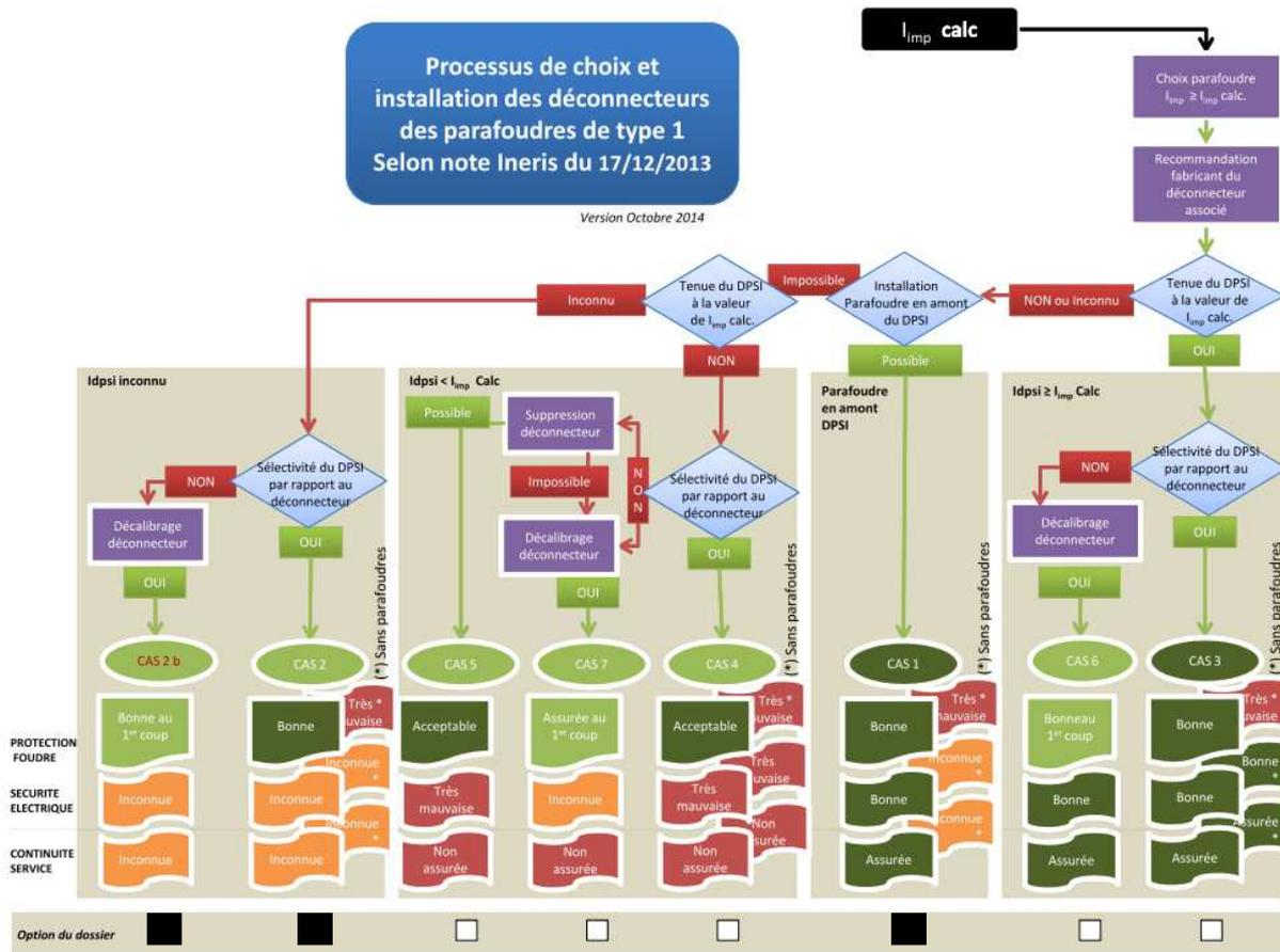
D'autre part, la coordination des différents parafoudres du site doit être assurée. Différents moyens, communiqués par les fabricants, permettent de garantir cette coordination. Il peut s'agir d'une association prévue dès la conception du produit, de contraintes sur les longueurs de câble minimum entre les deux étages de protection ou de la mise en œuvre d'inductance de découplage.
